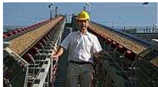
Betriebsleiter Thomas Derksen steht zwischen den neuen Förderbändern der Aufbereitungsanlage. Getrennt wurde der Sand an dieser Stelle bereits in vier so genannte Fraktionen mit unterschiedlichen Korngrößen. RP-Fotos: Ekkehart Malz
